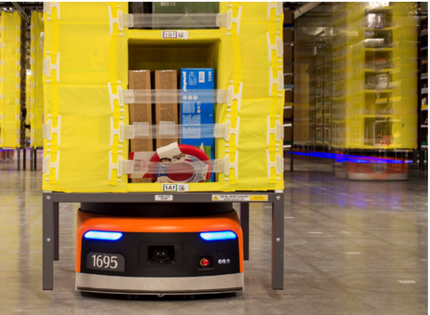
Robots logistiques développés par Kiva Systems pour Amazon bientôt en service dans leur entrepôt de Brétigny.
